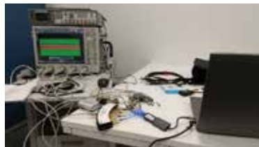
図2 HDMI2.1 ソース側のプレコンプライアンステスト環境の一部(左)と測定結果の一例(右)
