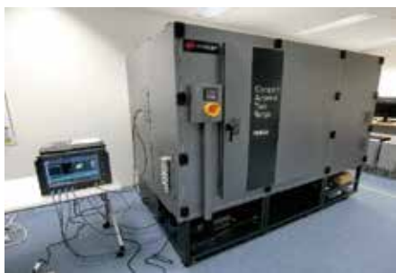
コンパクトアンテナテストレンジ外観
