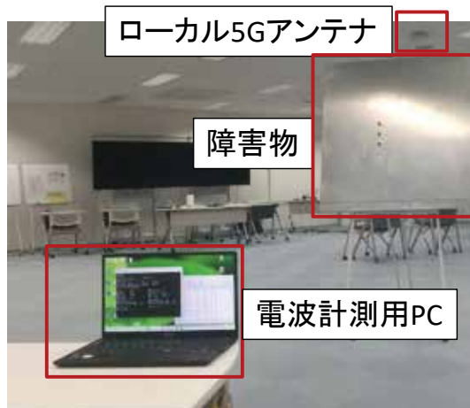
図 ローカル5Gアンテナ、電波計測用PCを用いて障害物の有無を検知した。
