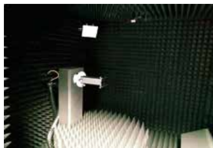
コンパクトアンテナテストレンジ内部
